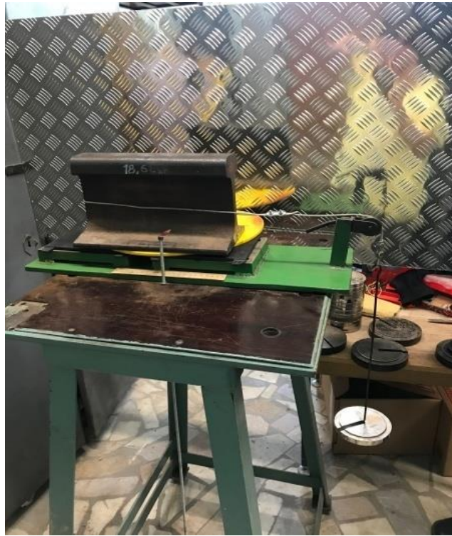
Рисунок 2.3 – Определение коэффициента трения между парой трения «полиамид - эластомер»
