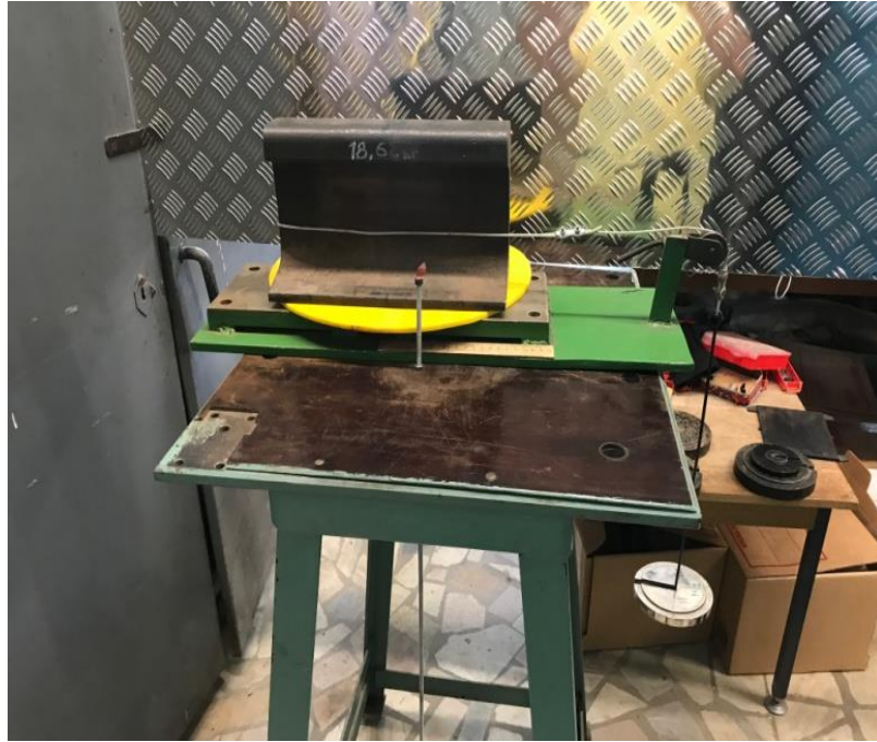
Рисунок 2.1 – Определение коэффициента трения между парой трения «металл - полиамид»
