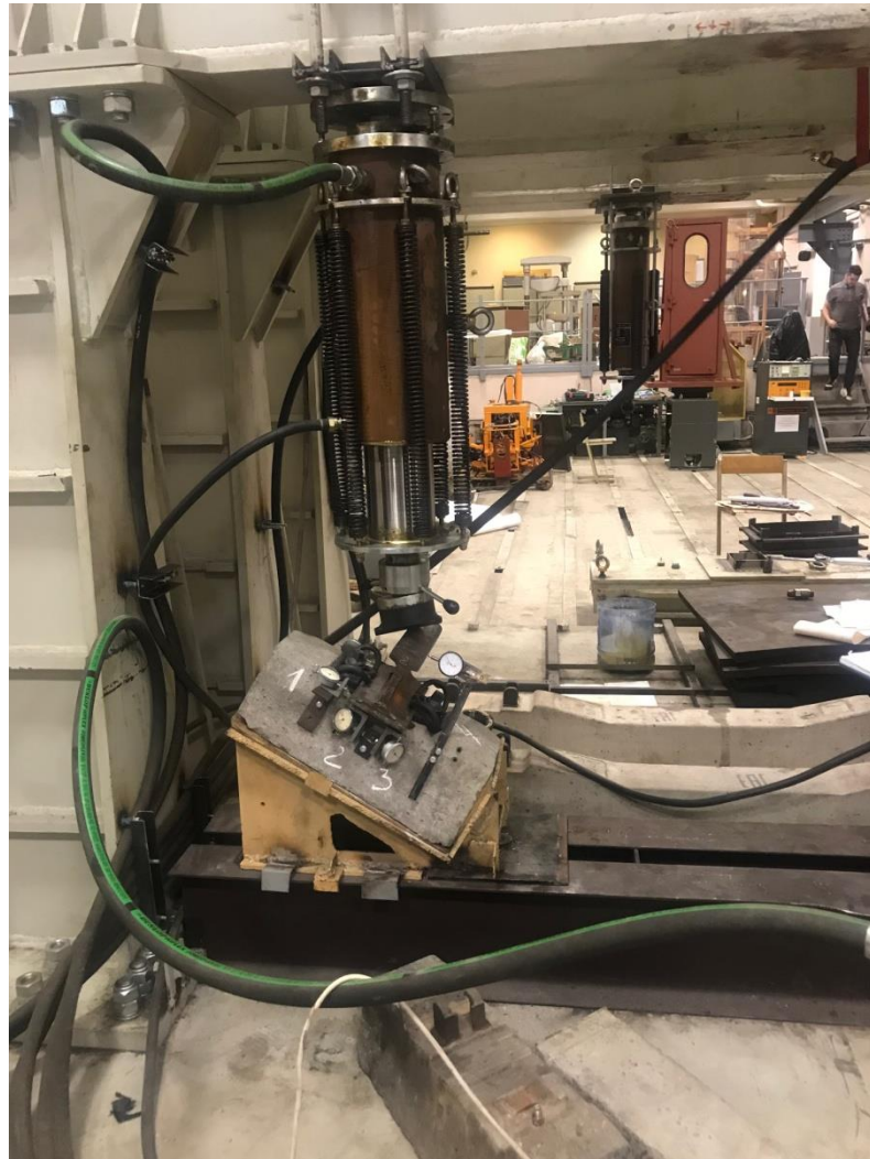
Рисунок 3.12 – Ресурсные испытания полиуретанового эластомера с иммитацией краевого опирания на стенде РУТ (МИИТ)
