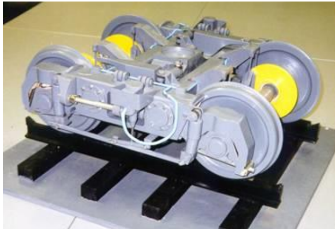
Рисунок 1.28 - Тележка модели Р.20.140 скоростного грузового вагона с торсионами и люлечным подвешиванием
