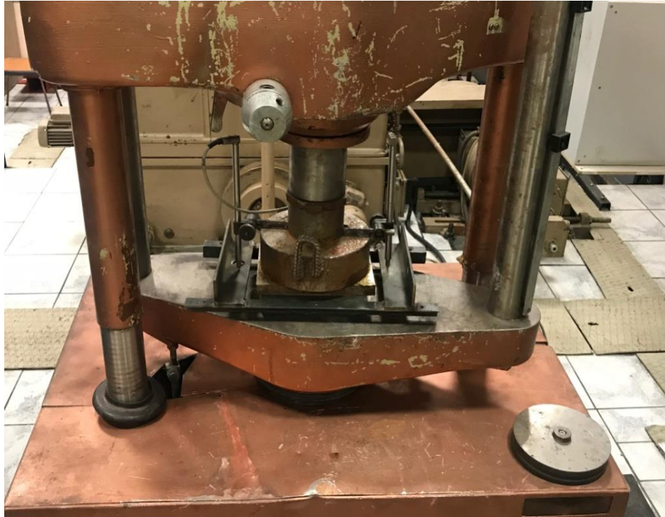
Рисунок 2.9 – Испытания эластомерных материалов для определения упруго-гистерезисных свойств
