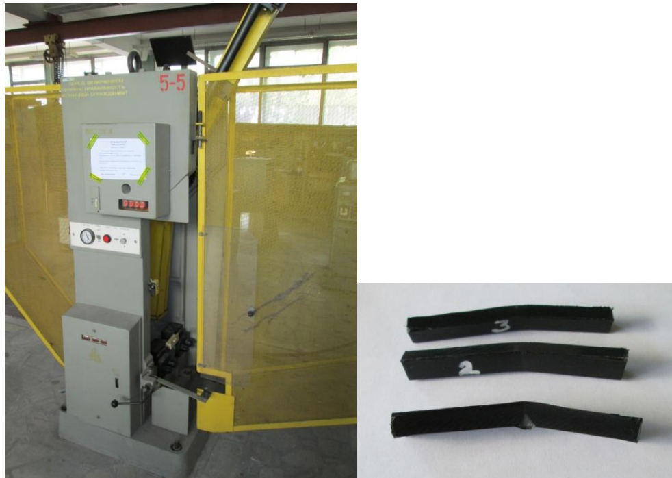
Рисунок 2.8 – Оборудование для определения ударной вязкости жестких полимеров и вид образцов после испытаний
