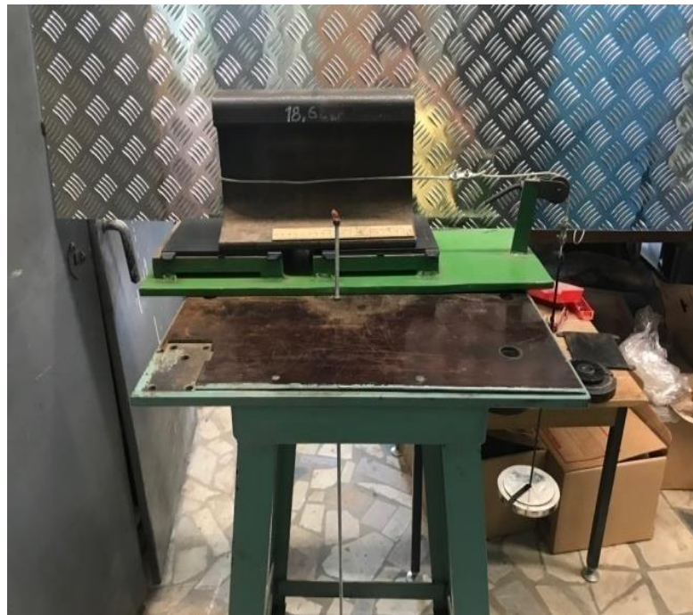
Рисунок 2.2 – Определение коэффициента трения между парой трения« металл - эластомер»
