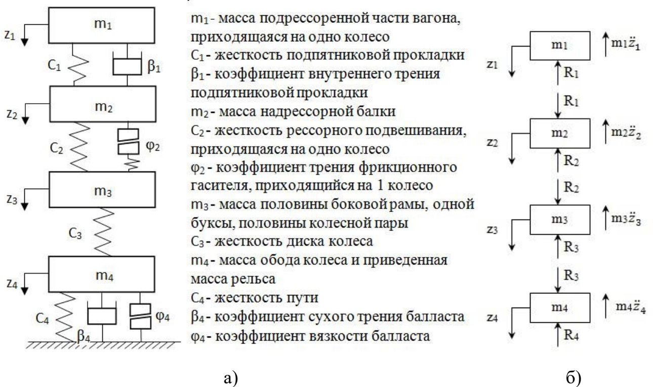
Рисунок 5.1 – Обобщенная модель (а) и расчетная схема (б) взаимодействия четырехосного вагона и железнодорожного пути
