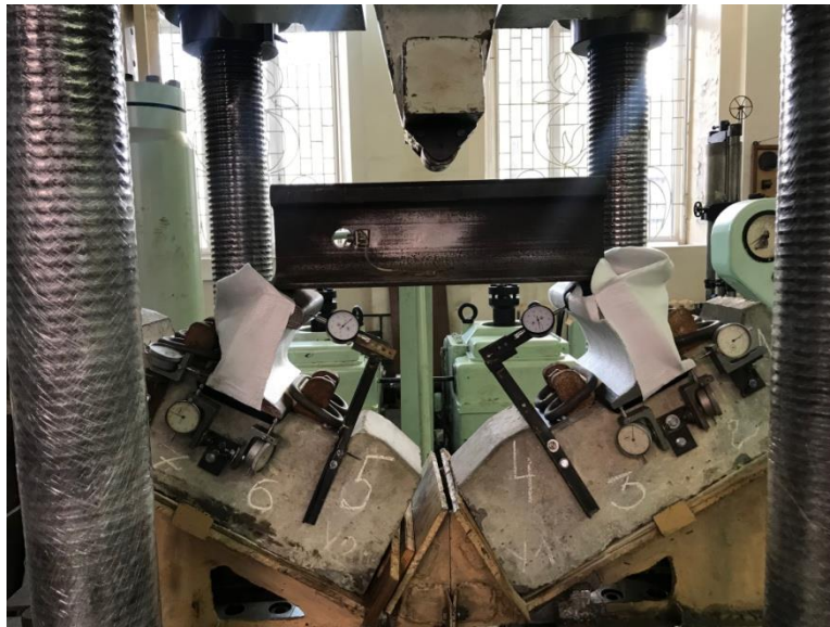
Рисунок 3.14 – Ресурсные испытания резинового эластомера на испытательной машине ЦДМ Пу-200 (цикл охлаждения)
