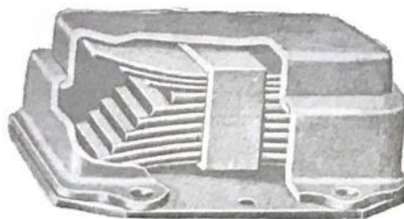
Рисунок 1.23 – Поглощающий боковой скользящий типа Буффало
