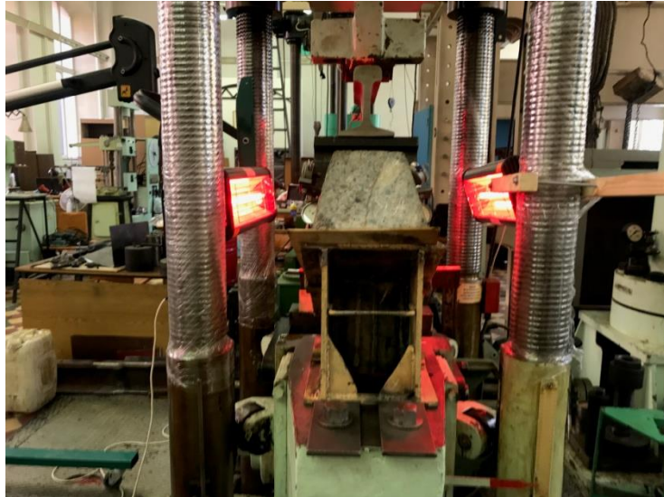
Рисунок 3.13 – Ресурсные испытания резинового эластомера на испытательной машине ЦДМ Пу-200 (цикл нагрева)
