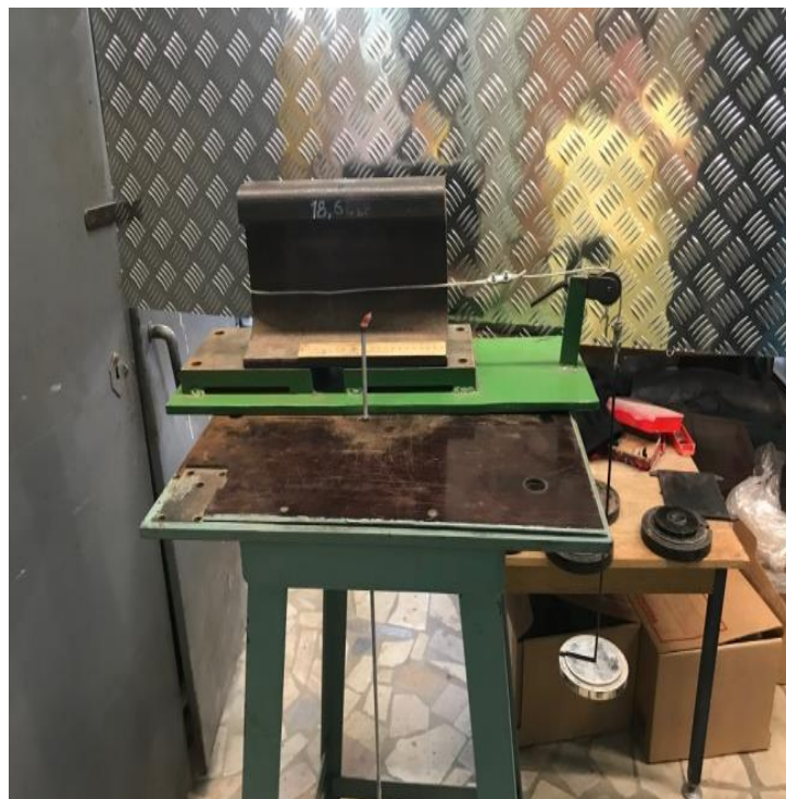
Рисунок 2.4 – Определение коэффициента трения между парой трения «металл-металл»
